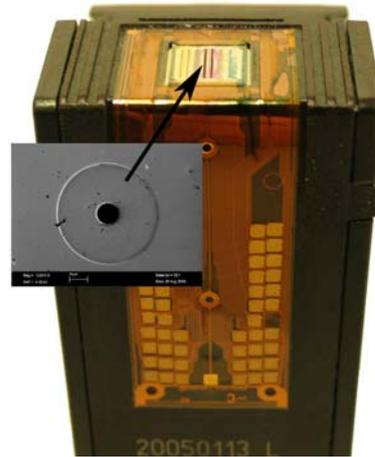
Abbildung 3: Druckerpatrone mit REM-Aufnahme der Düse
