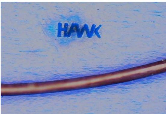
Abbildung 4: Mittels Blende beschrifteter Kunststoff (mit Haar als Größenvergleich)
